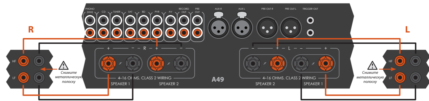
Устройство A49, подключенное к двум динамикам с помощью двойного подключения.
