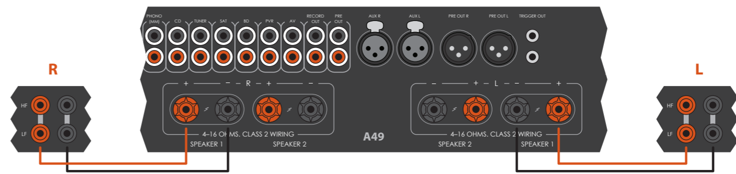
Усилитель A49 подключен к колонкам однопроводным соединением.
