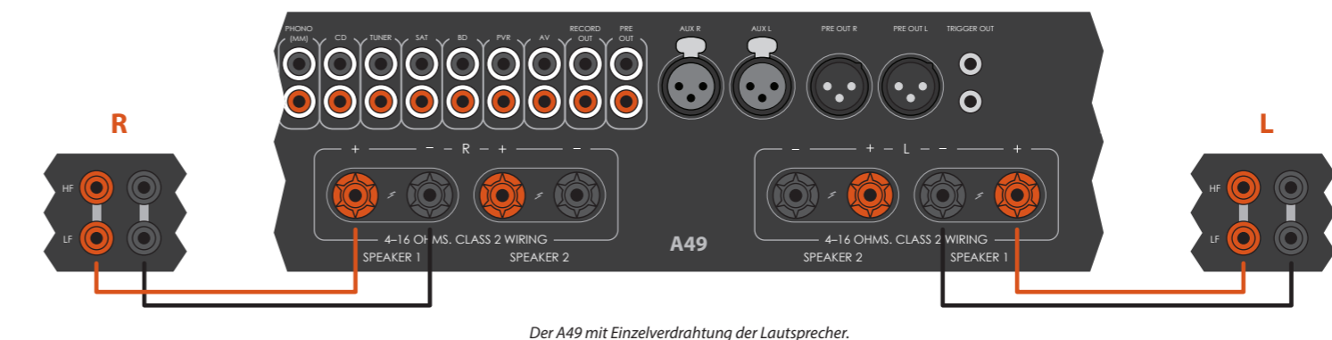
Der A49 mit Einzelverdrahtung der Lautsprecher.
