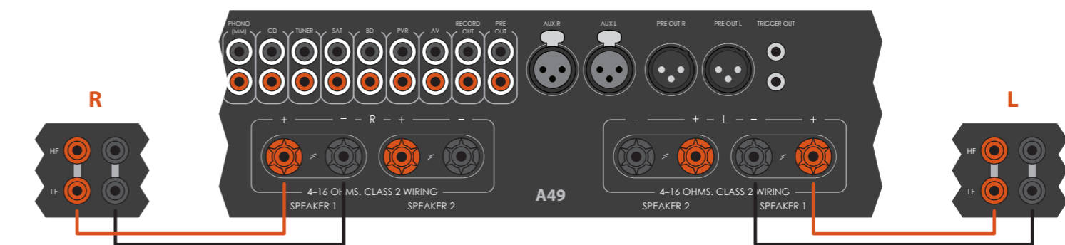
Een A49 aangesloten op luidsprekers met behulp van enkele bekabeling.
