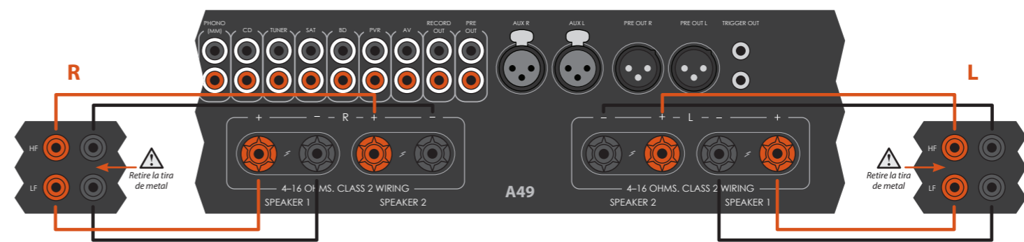
Un A49 conectado a dos conjuntos de altavoces usando el bicableado.
