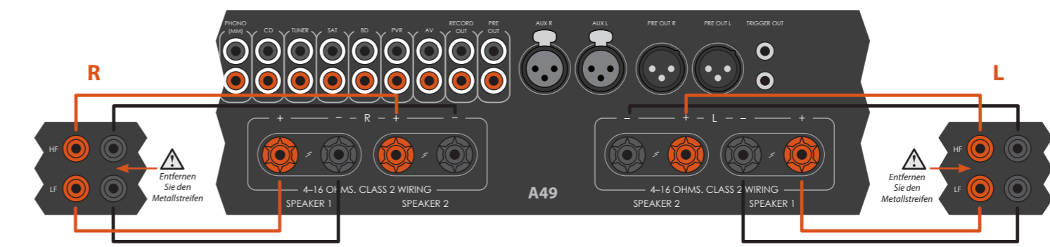
Der A49 mit Doppelverdrahtung von zwei Lautsprechergruppen.
